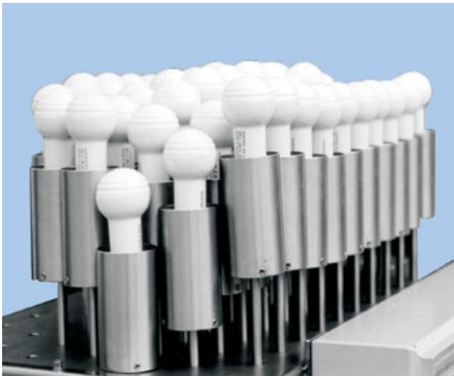
Bild 8: 3-D-Heizfeld zum Kaschieren von Türverkleidungen
